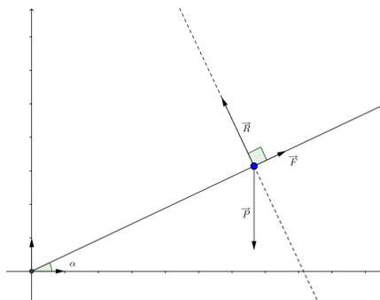
en fonction de  $\|\vec{P}\|$  et de  $\alpha$  une mesure (en radians) de l'angle fait avec l'horizontale par le plan incliné.
